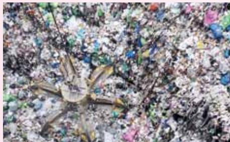
巨鉗把垃圾夾起並放入焚化爐，透過燃燒垃圾產生電力
